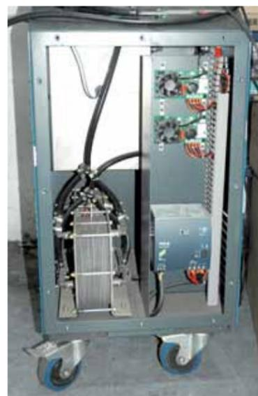
▲ L'incontestable innovation de la dernière station Hy-Calamine 1000 S « EGR pilot » est la fonction qui permet le pilotage automatique ou manuel de la vanne EGR. En mode automatique ce pilotage s'appuie sur un cycle de 15 minutes (5 d'ouverture, 5 de fermeture et 5 d'alternance) reproduit à quatre reprises sur la durée totale du traitement.
