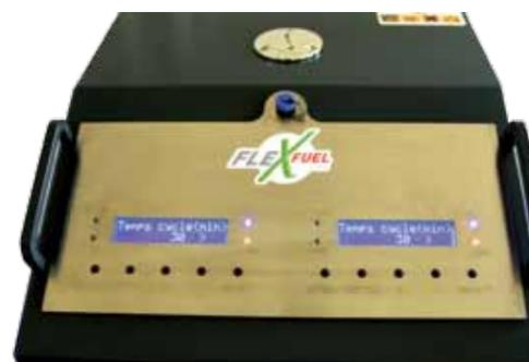
▲ L'ensemble des commandes de la station est regroupé sur le tableau digital. Il permet d'accéder aux programmes ou de reprendre la main sur le fonctionnement de la machine.
