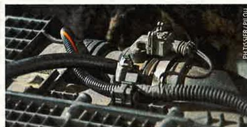
**L'hydrogène est injecté directement dans l'admission, alors que le moteur tourne au ralenti. Dans le même temps, la machine commande la vanne EGR par différents cycles d'ouverture et de fermeture.**
