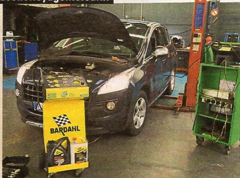
Bardahl a conçu une machine compacte, capable de régénérer selon trois cycles distincts injecteurs, admission d'air et Fap. Dans chaque cas, un produit dégrasant est injecté dans les organes encrassés afin d'éliminer suies et calamine.
