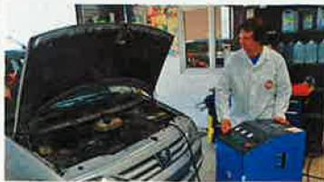
Les pièces mobiles de la géométrie variable sont sensibles à l'encrassement. Une fois par mois, moteur chaud, un trajet autoroutier réduira le phénomène. Au besoin, un dégrasage peut être fait par le concessionnaire à l'aide d'un additif professionnel ou dans un centre proposant le décalaminage à l'hydrogène (Decalaminage-moteurs.fr, photo ci-dessus).
