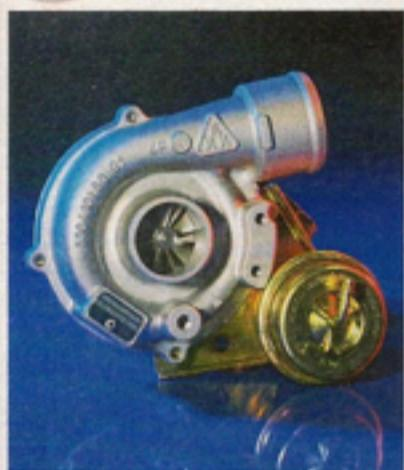
**LES SYMPTÔMES:** fumée bleue, sifflement, surconsommation d'huile et pertes de puissance.
