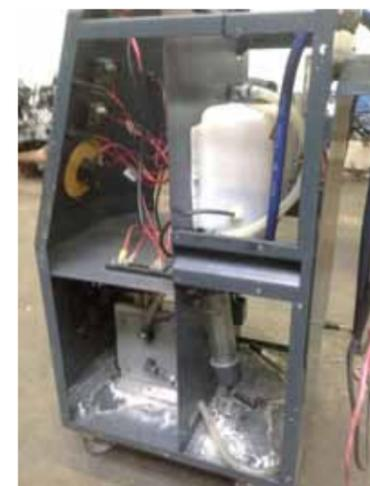
▲ Certaines machines affichent une qualité de fabrication douteuse qui se traduit par une corrosion avancée du châssis après seulement quelques centaines d'heures de fonctionnement.
