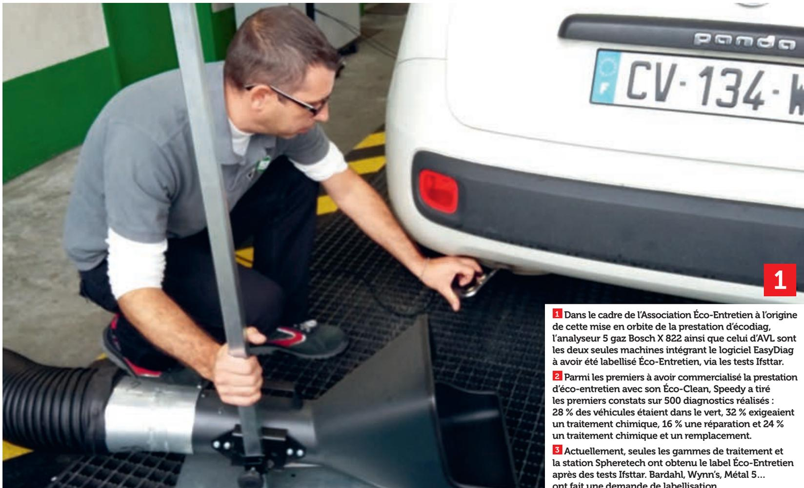
**1** Dans le cadre de l'Association Éco-Entretien à l'origine de cette mise en orbite de la prestation d'écodiag, l'analyseur 5 gaz Bosch X 822 ainsi que celui d'AVL sont les deux seules machines intégrant le logiciel EasyDiag à avoir été labellisé Éco-Entretien, via les tests Ifsttar.
