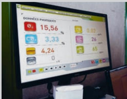
**L'ANALYSEUR 5 GAZ SPÉCIFIQUE ÉQUIPÉ DU LOGICIEL EASYDIAG** développé par Spheretech effectue un bilan complet des dysfonctionnements de combustion du système d'injection.
